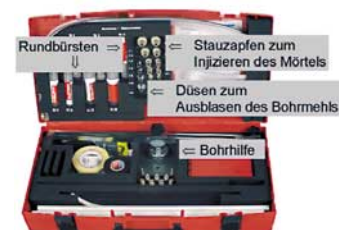
Abb. 13: Ein Ausschnitt der System-Palette: Im Koffer sind die zur Montage und Injektion notwendigen Werkzeuge mit der Bohrhilfe zusammengefasst.
